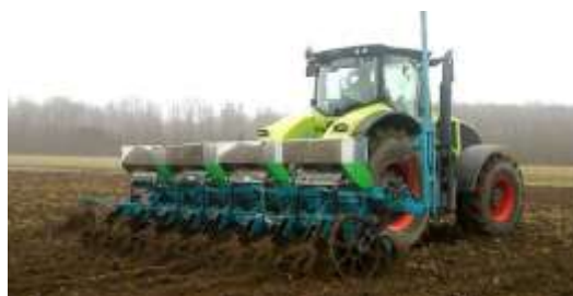
Рис. 6. Агрегат АСОГ-8 з обладнанням для внесення твердих мінеральних добрив
