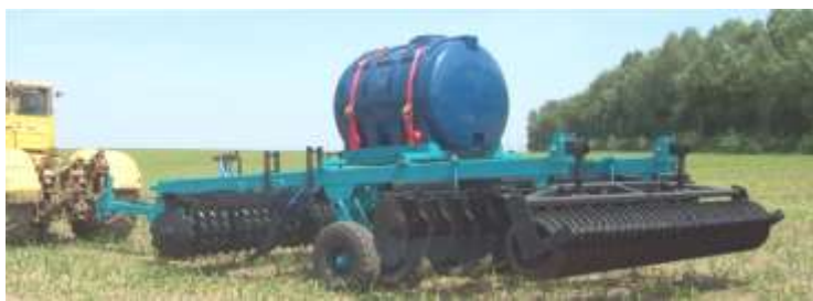
Рис. 7. Диско-чизельна борона БДВП-4,2-03 з обладнанням для внесення рідких добрив і біодеструкторів
